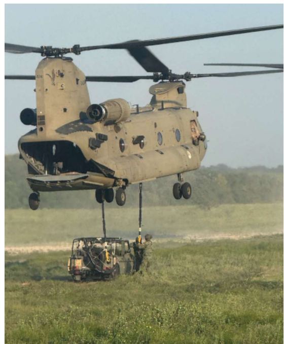
Aanhaken van een MB 7,5kn aan een CH-47
