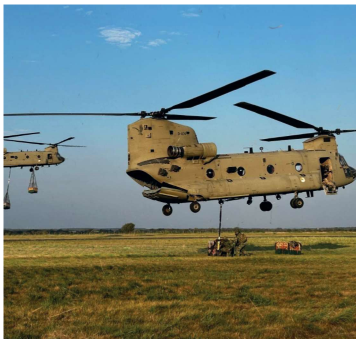
Aanhaken van dual pallet loads onder een CH-47
